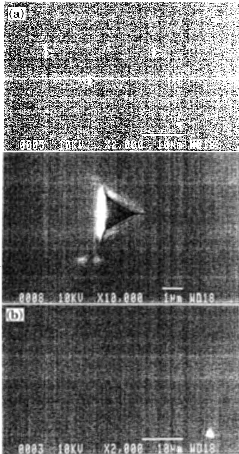
図 2 - 1 4 (111) A 面 GaAs 表面からの As 抜け状態 (a) 上図：硫酸エッチャント処理(5:1:1)、下図：As 抜けピットの拡大図 (b) アンモニアエッチャント処理(2:1:96)
