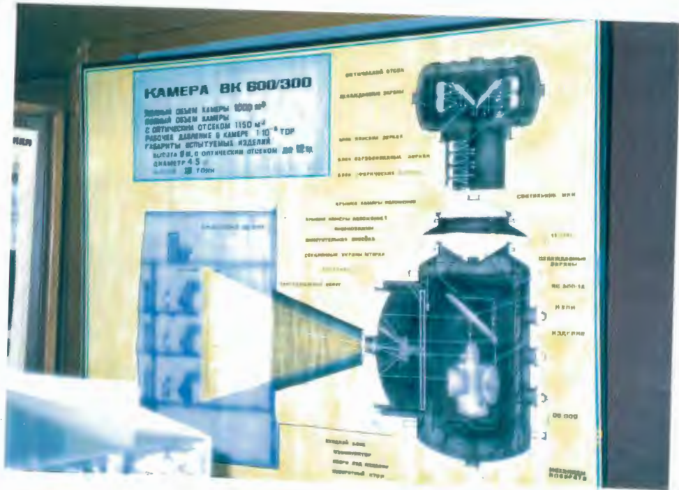
写真 1 5 熱実験用チャンバ実験構成図
