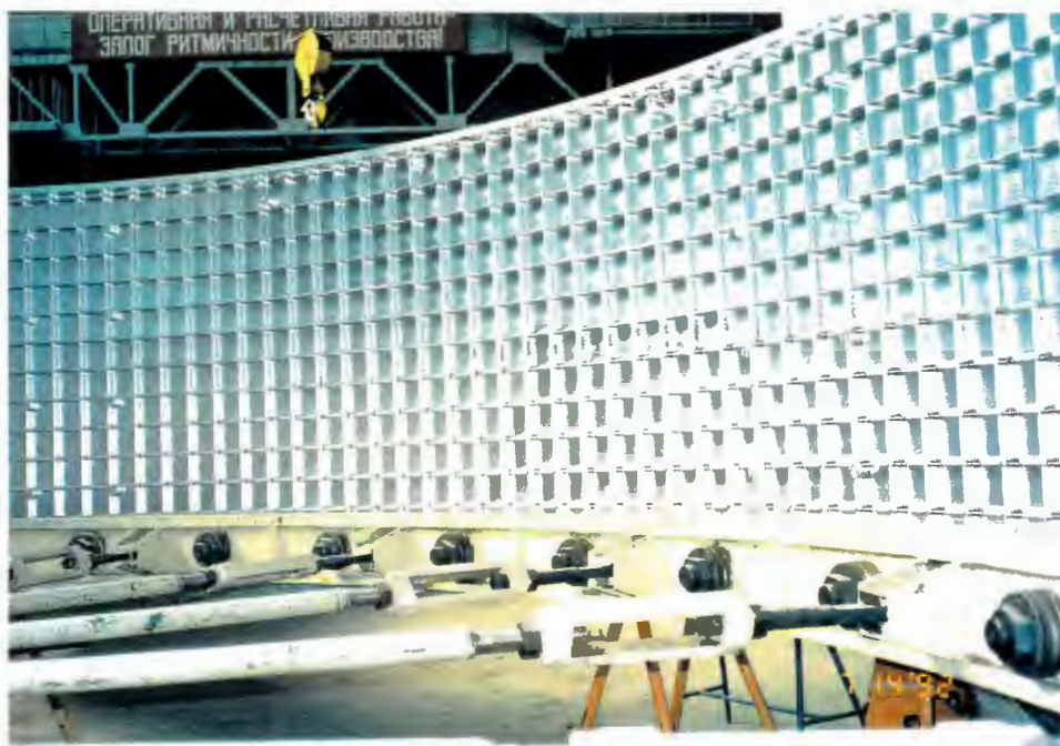
写真 2 5 燃料タンク内壁（直径 8 m，スカンジウム・アルミ合金）
