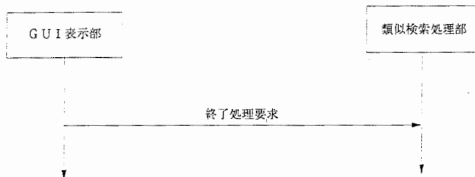
図 3.5: 類似検索システム終了時のソケット通信手順
