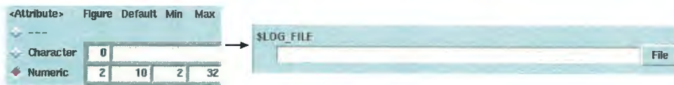
Figure 4.53: 数値引数 (固定小数点数) の指定 (左) と、作成されるウィジェット (右)
