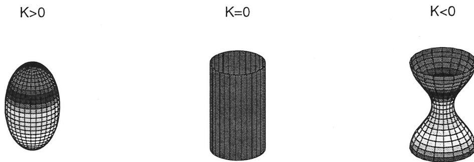
図 1.1 ガウス曲率により分類された面の形状
