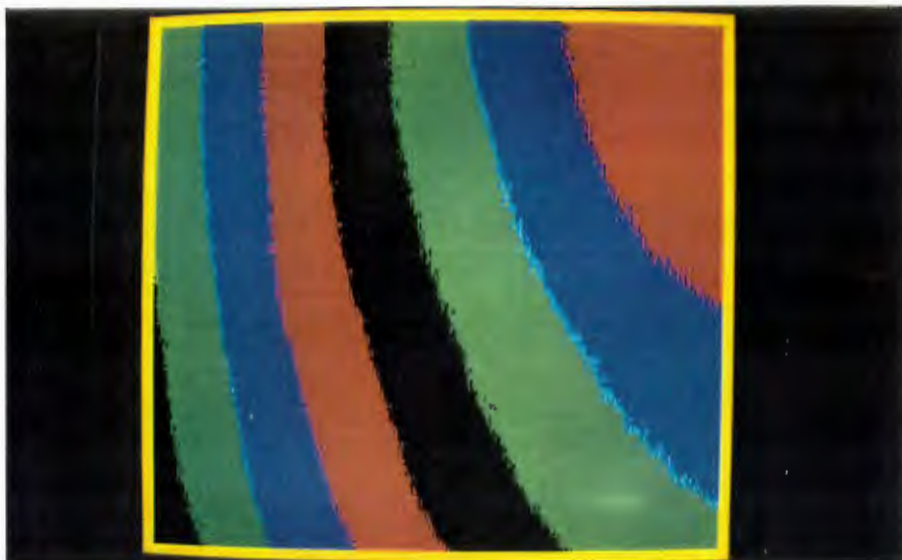
写真4-4 平面のモアレ縞のパターン（レンズのズームがやや小さい）
