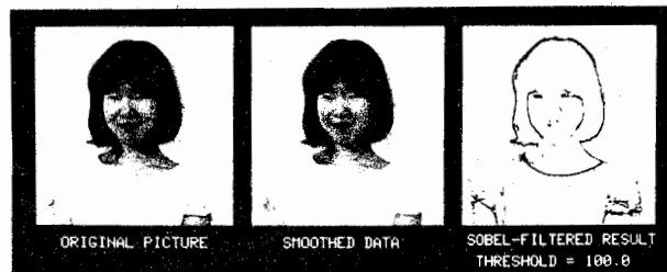
図5. 原画像(256×256,8bit)および Sobelの1次微分の結果例
