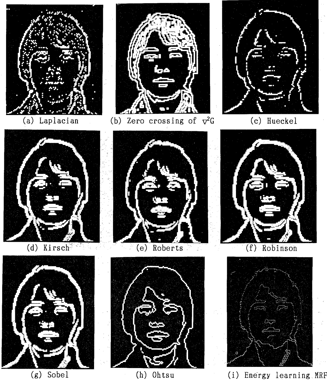
図9. 従来手法により求めた輪郭画像
